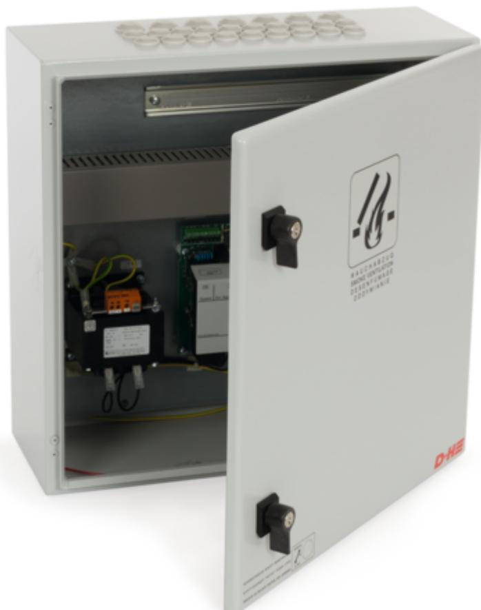
Bei unserer RWA Zentrale RZN 4416-M sitzt die Platine bereits fest im Gehäuse. Für 2 Brandabschnitte, 3 Antriebsgruppen sowie 1 Erweiterungsplatz. AdComNet ready. VdS zertifiziert nach ISO 21927-9, erfüllt die DIN 18232-9.
