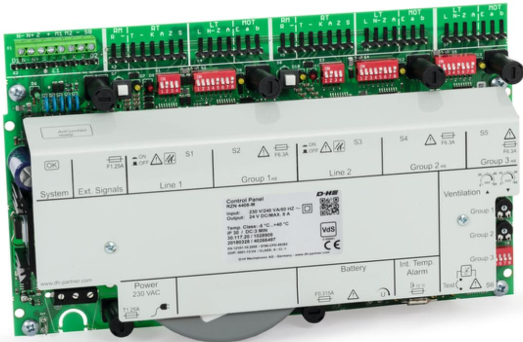
Unsere Modularzentrale sorgt für die Ansteuerung von RWA-Antrieben bis 8 A Antriebsstrom. Für 2 Brandabschnitte, 3 Antriebsgruppen & 1 Erweiterungsplatz. AdComNet ready. VdS zertifiziert nach ISO 21927-9, erfüllt die DIN 18232-9.
