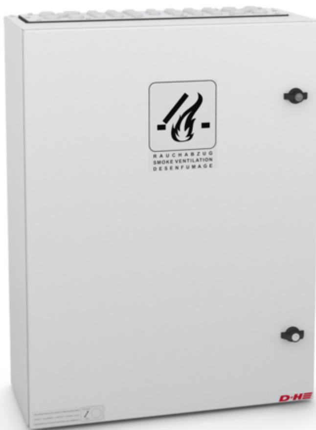
Diese CPS-M sorgt mit Laststrom von 40 A, bis zu 6 kombinierten RT- & RM-Linien sowie 6 ansteuerbaren Motoranschlüssen für Rauch- & Wärmeabzug. VdS zertifiziert nach ISO 21927-9, erfüllt die DIN 18232-9.
