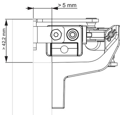
Für aufgesetzte Montage, Drehfenster einwärts öffnend.
