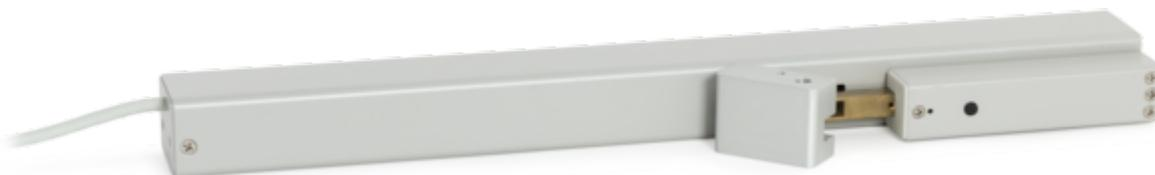
Dieser Fensterantrieb hat den Dreh raus: Bis zu 1,2 m x 1 m große Flügel öffnet der Drehflügelantrieb SHD 54 – in weniger als 30 Sekunden auf bis zu 65°.
